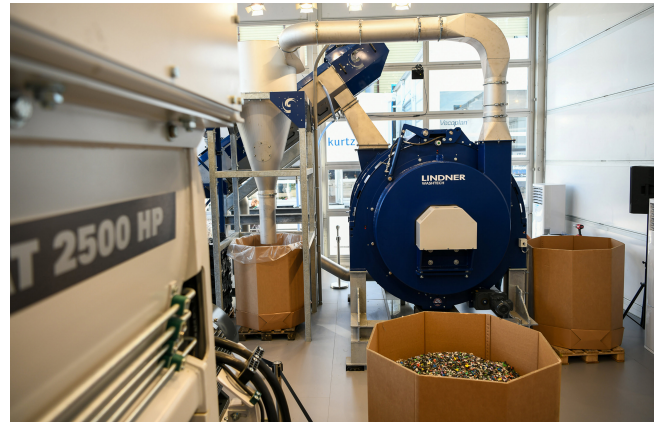
Bild 4. Auch Lindner machte das Recycling erlebbar. In drei täglichen Vorführungen wurden unterschiedliche Post-Consumer-Hartkunststoffe live zerkleinert – und erstmals auch nass gewaschen. © Lindner
